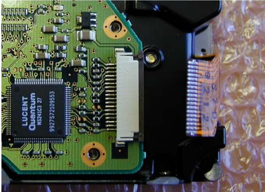
5 ). ネジ5本とフレキシ基板を外した後は下の写真の赤丸の部分で、基板とハードディスク本体が繋がっているだけになります。
