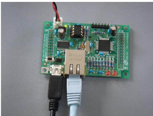
JP1 を外し、5V 電源を CN3 に接続して、USB ケーブルを接続します。
