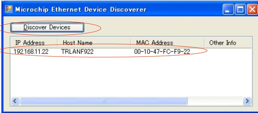
起動すると上図のように接続しているボード(TRLANxxxx)が表示され、MAC アドレスと割り当てられた IP アドレスが表示されます。xxxx は MAC アドレス下位 2byte が入ります。
